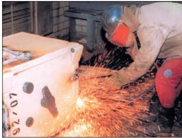
Abb. Prüfmethode mit Schneidbrenner Prüfmethode mit Diamantkronenbohrer
